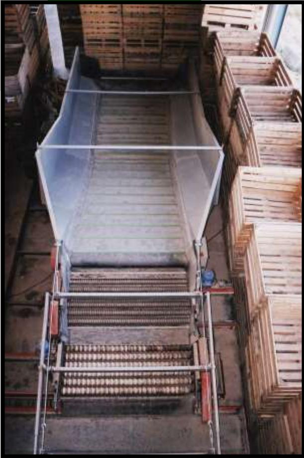
Ensemble maxi bunker pour une plus grande capacité du produit avec pré-calibreuse à la sortie.
