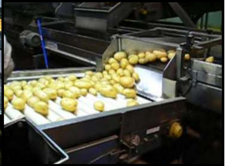
Détail des Tables d'inspection travaillant sur plusieurs lignes de pommes de terre. Les entrées du produit se réalisent très doucement pour obtenir un bon traitement du même.
