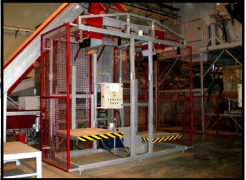
Modèle hydraulique pour des productions de 25 tonnes/h. très robuste et avec un traitement soigné du produit. Comme dans tous les modèles le décrochage du sac est automatique.
