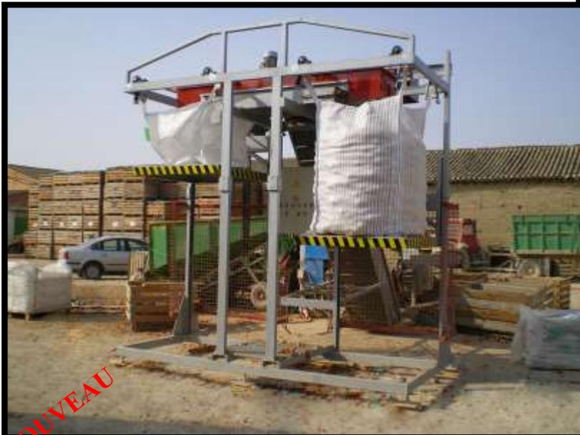
Modèle électromécanique pour productions de 25 tonnes/h. totalement mécanique, très silencieux et avec une hauteur initiale de décharge très réduite, ce qui donne un traitement très doux du produit.
