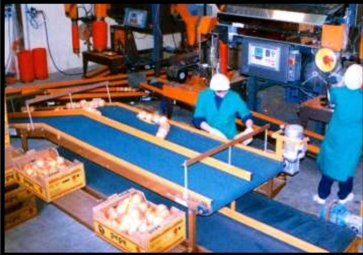
Les tapis roulants et les élévateurs peuvent être construits en acier peint ou en acier inoxydable. Les dimensions de la machine s'ajustent aux besoins du client. L'option d'artesa fait que le produit est centré sur la machine, empêchant qu'il se frotte contre les bords du tapis.
