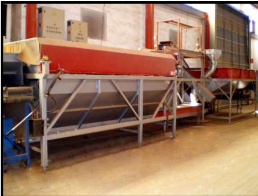
Équeuteuse montée en ligne. Châssis très robuste et étanche avec un tapis roulant inférieur pour le ramassage du rebut. Production de 8 tonnes/heure jusqu'à 12 tonnes/heure maximum, selon modèle.
