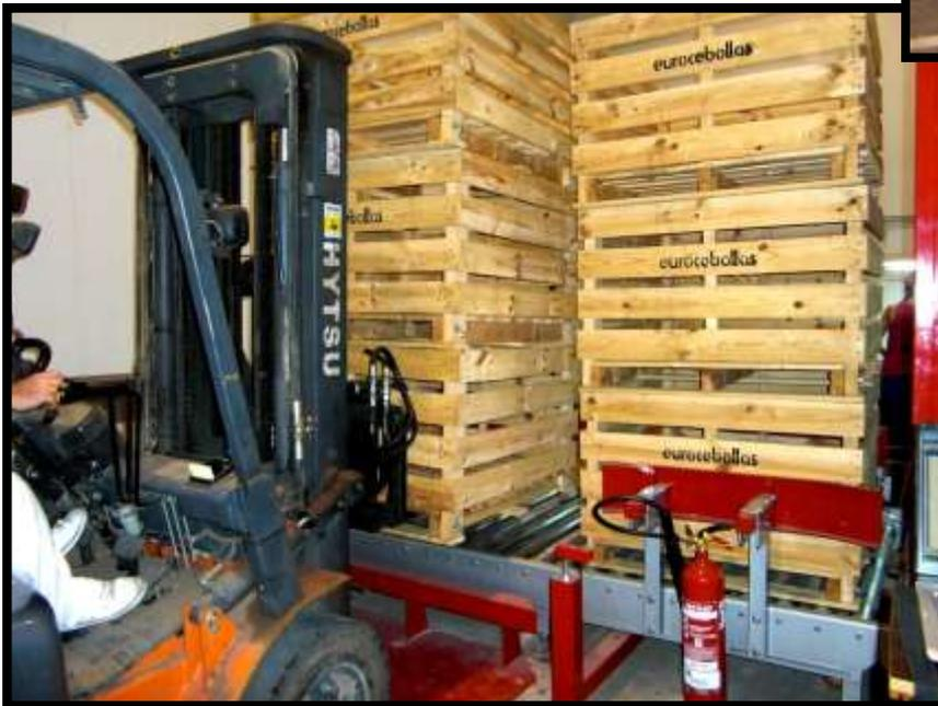
Détail des colonnes du palettiseur et dépalettiseur durant son fonctionnement. Pour travailler avec la machine il est seulement nécessaire un opérateur, qui s'occupe d'actionner la pédale pour le changement de palox plein par un palox vide et mise en place du produit pour une dernière inspection.
