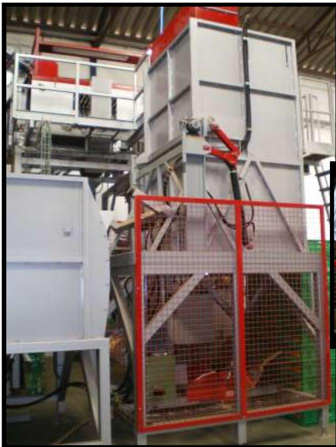
**Videur de big bags avec couvercle fixe réglable de façon manuelle et porte de sortie du produit.**
