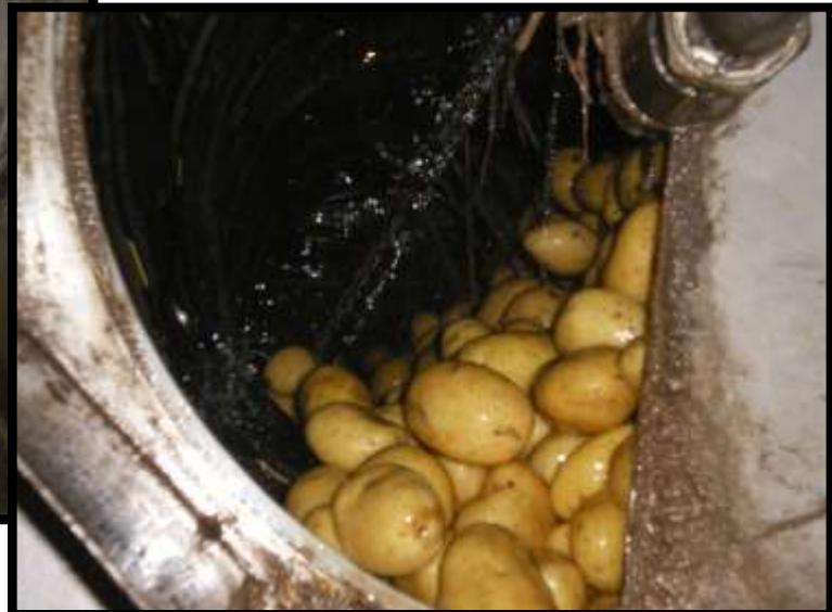
Détail de la sortie d'eau a pressions dans le modèle à douches. Les pommes de terre se frottent entre elles ce qui augmente le niveau de nettoyage du produit.
