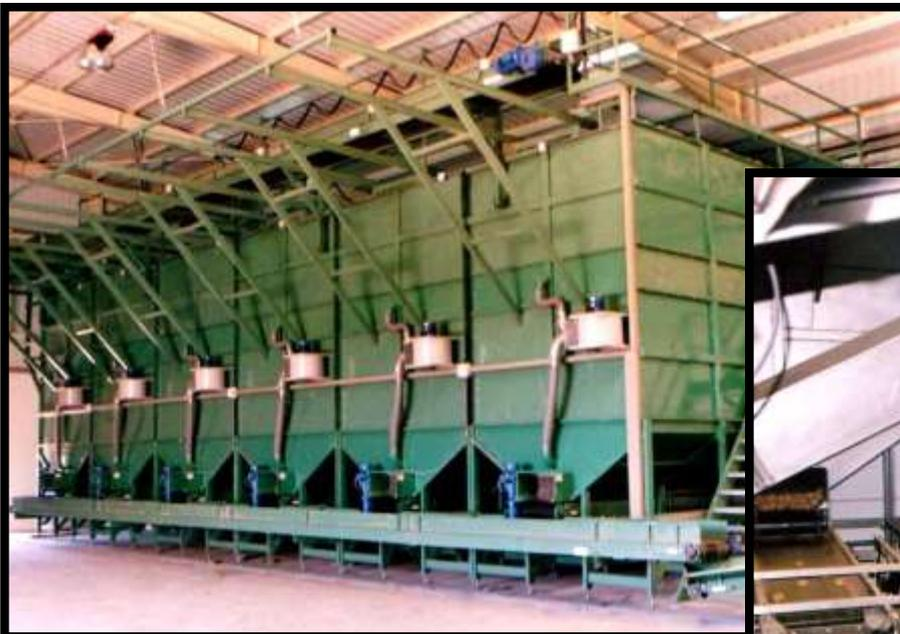
Détail d'un ensemble de six silos avec système de ventilation. La structure supérieure appartient au système de tapis déplaçables qui servent au remplissage.
