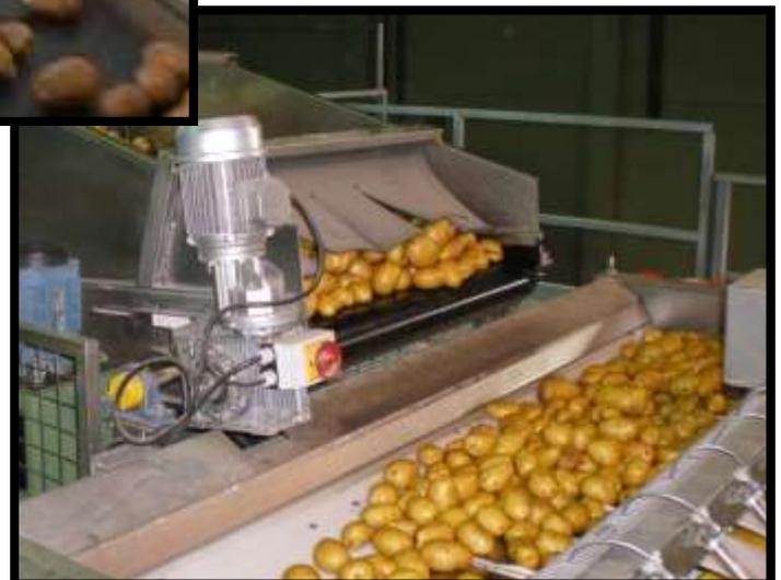
Dans les tapis à poumon, la machine descend automatiquement pour recevoir une plus grande quantité de produit sans devoir arrêter le travail. Cela s'obtient moyennant un système hydraulique et de photocellules.
