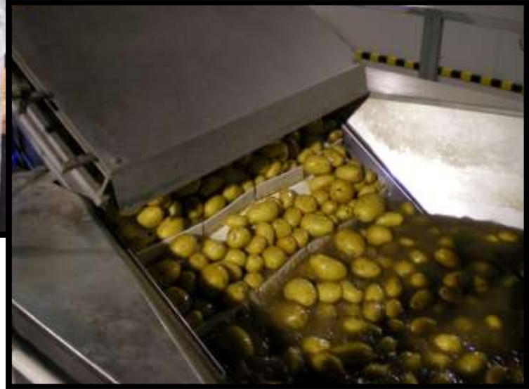
Élévateur pour la sortie du produit avec douches pour le rinçage final. La sortie du produit s'effectue avec soin.
