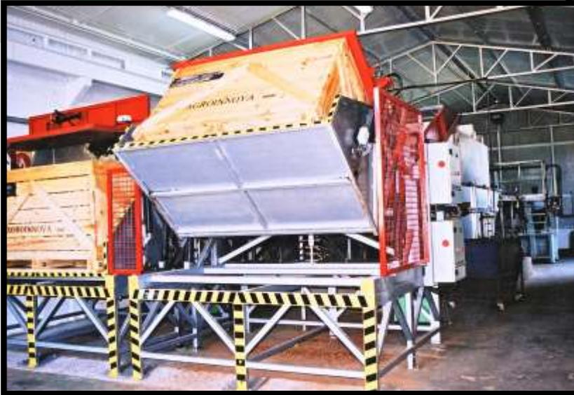
**Machine à vider les palox avec couvercle réglable en hauteur, de façon automatique et porte de sortie du produit. Capacité de 40 palox/heure.**
