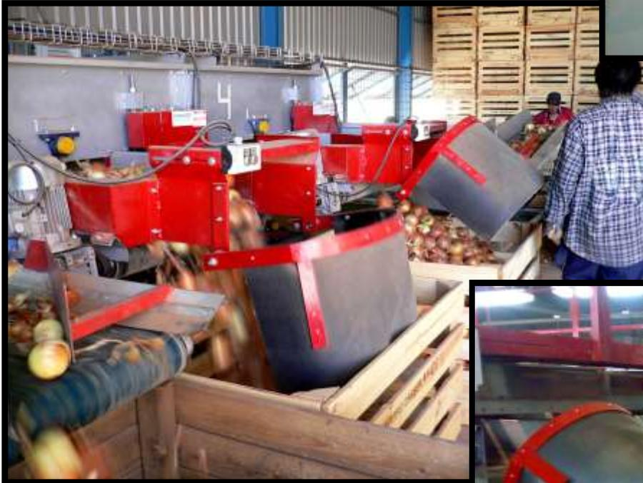
A l'aide d'un petit cadre électrique et de photocellules on peut automatiser totalement l'amortisseur.
