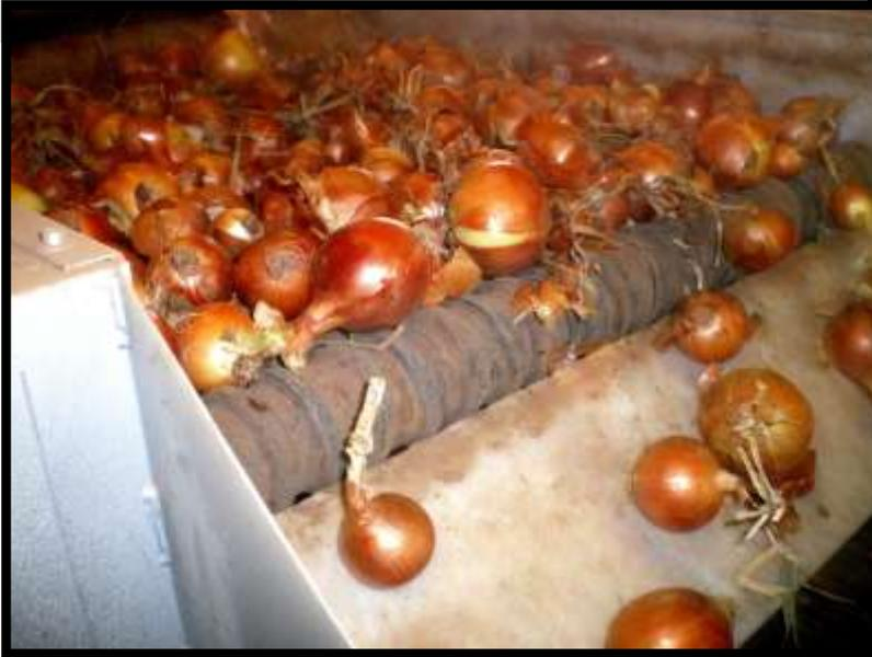
**Modèle d'éliminateur avec élastiques hélicoïdales travaillant avec des oignons.**
