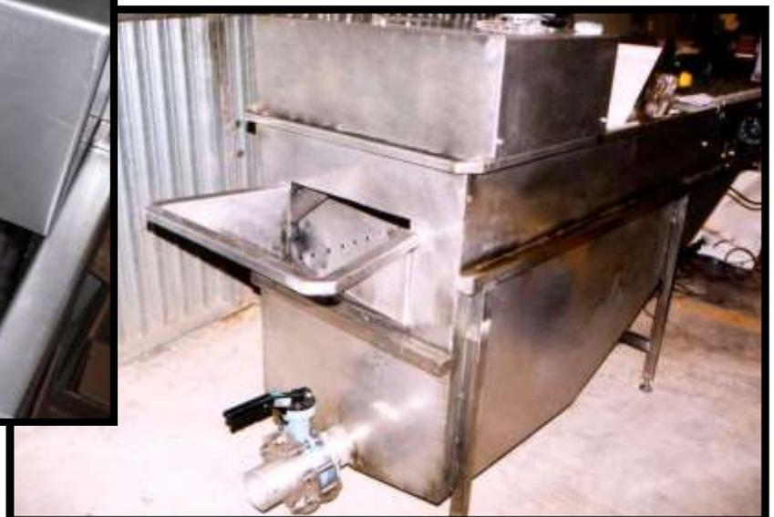
Détail de la bouche d'entrée du produit, et de la valve manuelle de la vidange d'eau.
