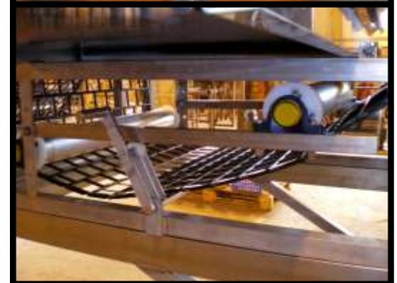
**Détail du tendeur du filet dans les deux positions, avec le filet tendu et détendu**
