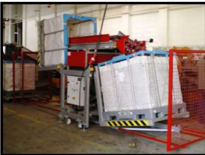
Détail de la machine en train de travailler avec de l'oignon rouge. Les caisses sont levées jusqu'à atteindre presque une position horizontale.
