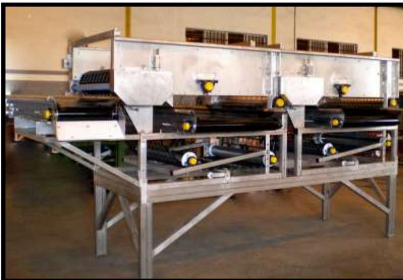
**Ensemble d'un calibreur 2+R. Il peut être construit en acier peint ou acier inoxydable.**
