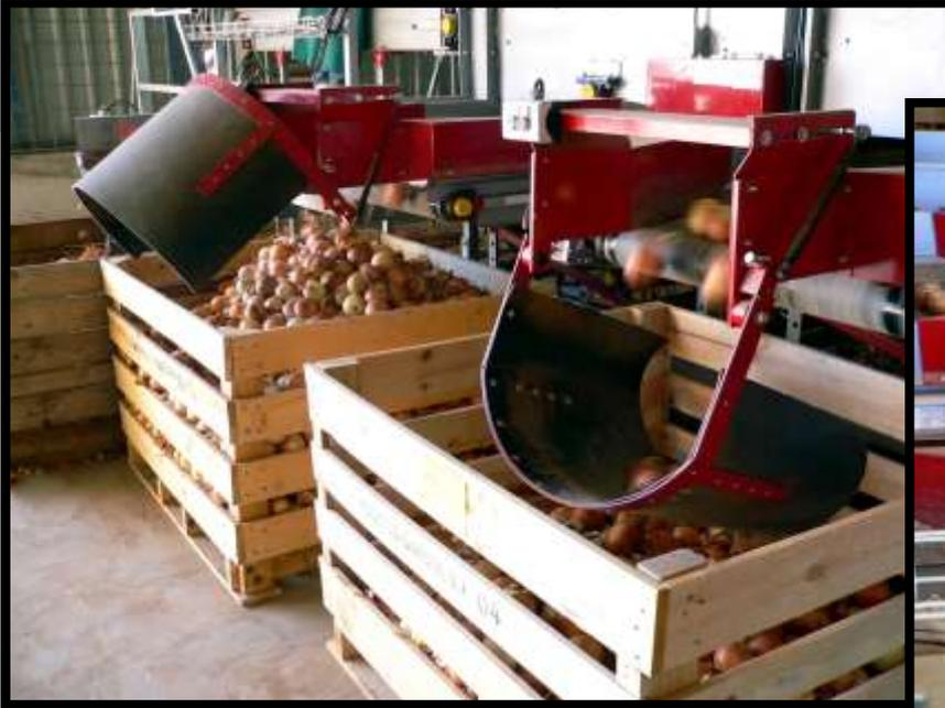
L'amortisseur semi-automatique est un système simple et économique pour faire descendre le produit d'une façon douce dans les caisses. On les construit pour toutes largeurs de bande.
