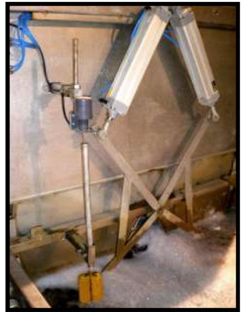
**Système pneumatique d'ouverture de portillons de la machine à laver à tambour immergé.**
