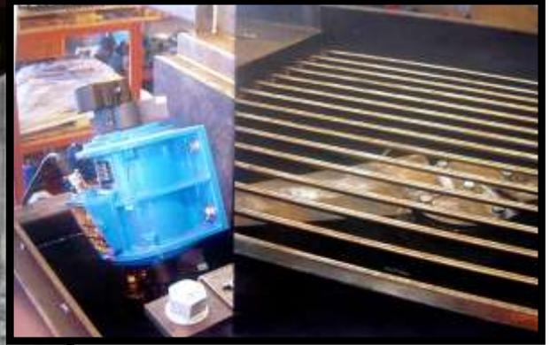
Détail des pâles et des vibrateurs. La séparation entre grilles est facile à varier, on a besoin seulement de changer le plateau.
