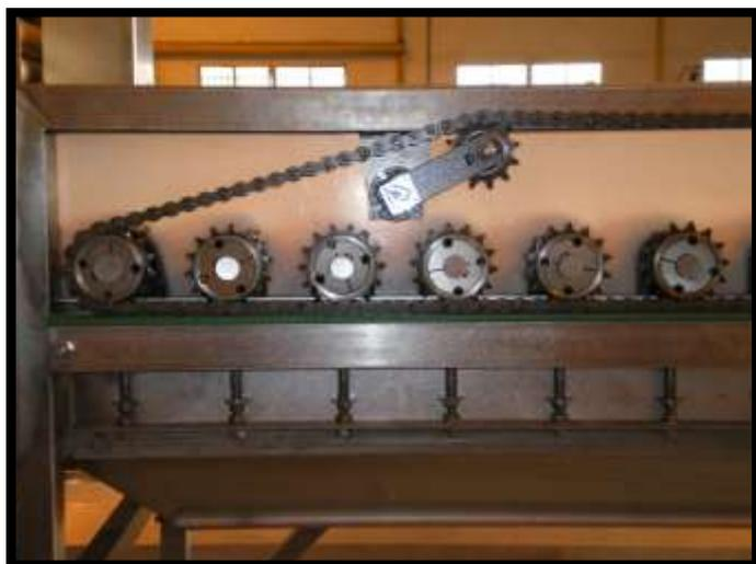
**Détail du système de transmission de l'essoreuse. Il y a un tendeur automatique et des pignons traités et renforcés. Cela nous amène a un entretien presque nul.**
