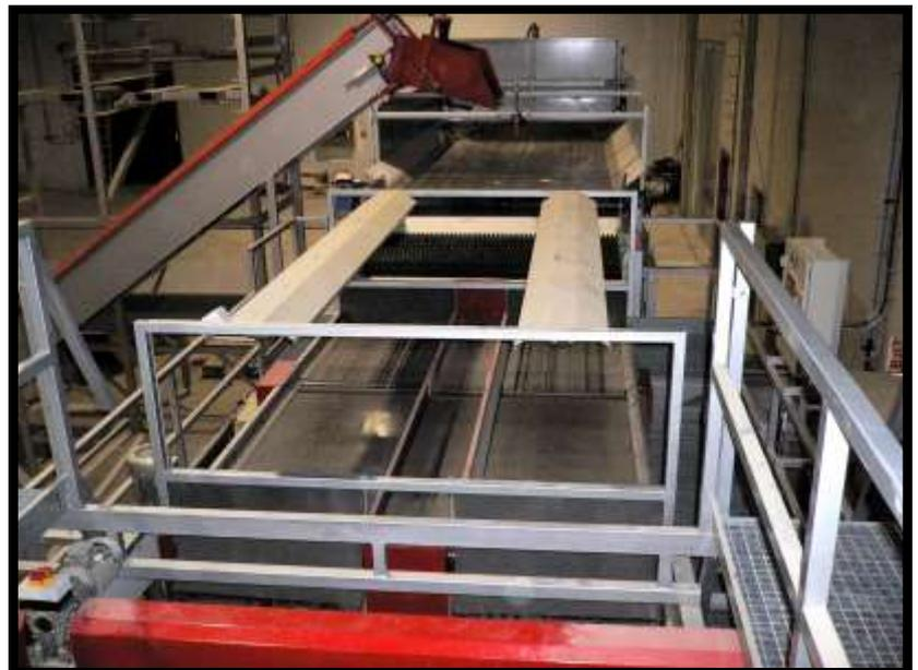
Détail des tables d'inspection en différents points d'une installation.
