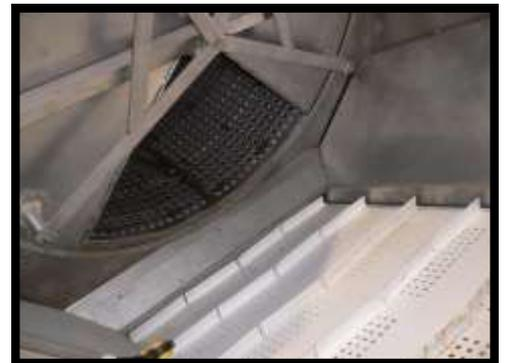
**Tambour construit avec une tôle perforée prévue pour le bon traitement du produit.**
