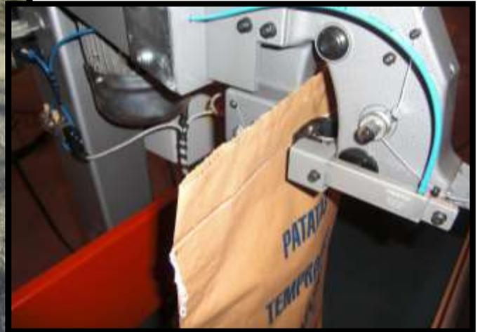
Détail de la machine cousant un sac. La couture se compose de trois fils traissés à gauche avec coupure automatisée par chaîne. Il est possible de régler, facilement et avec commodité, la hauteur de la bande pour les différents types de sacs.
