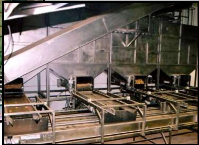
Détail d'un ensemble de silos en acier inoxydable muni d'un portillon d'accès intérieur et système de tapis roulants pour la sortie du produit.
