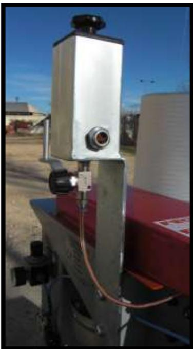
Détail du système d'engraisement par gravité.
