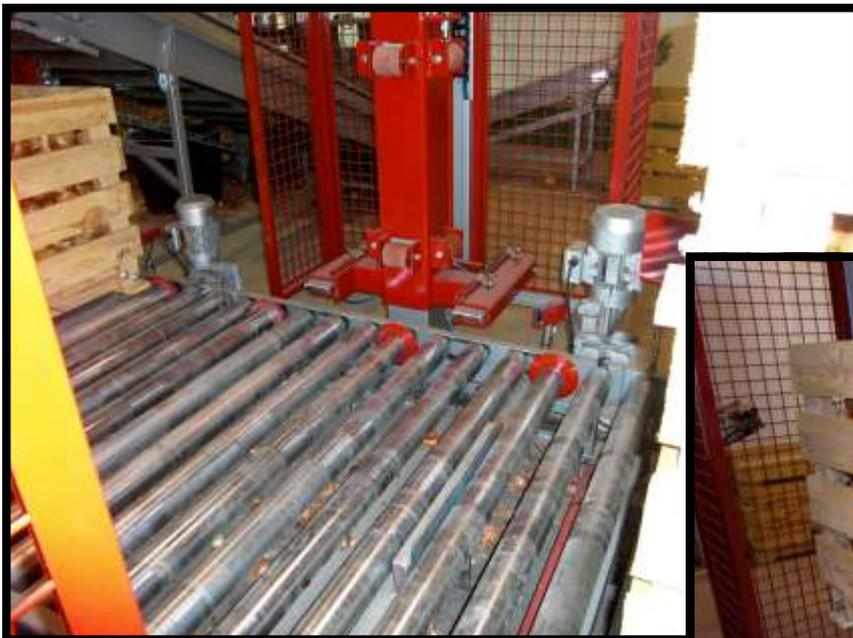
Détail du système de charriot d'élévation de palox et du système de transporteurs à rouleaux.
