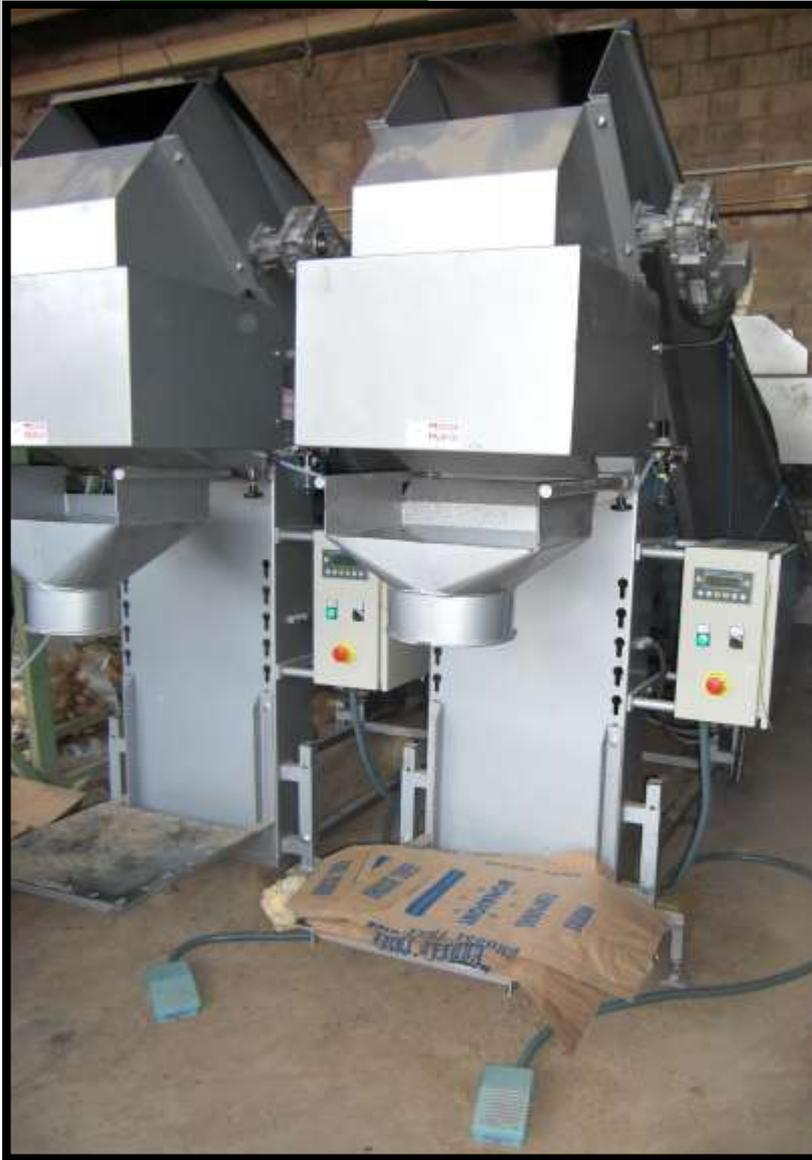
Production de 5.000 Kg /heure dans des sacs de 25 Kg et de 3.000 Kg /heure dans des sacs de 15 Kg, suivant le produit.
