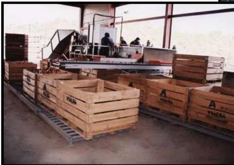
Détail du tapis à rouleaux. Il facilite et augmente la vitesse de déchargement.
