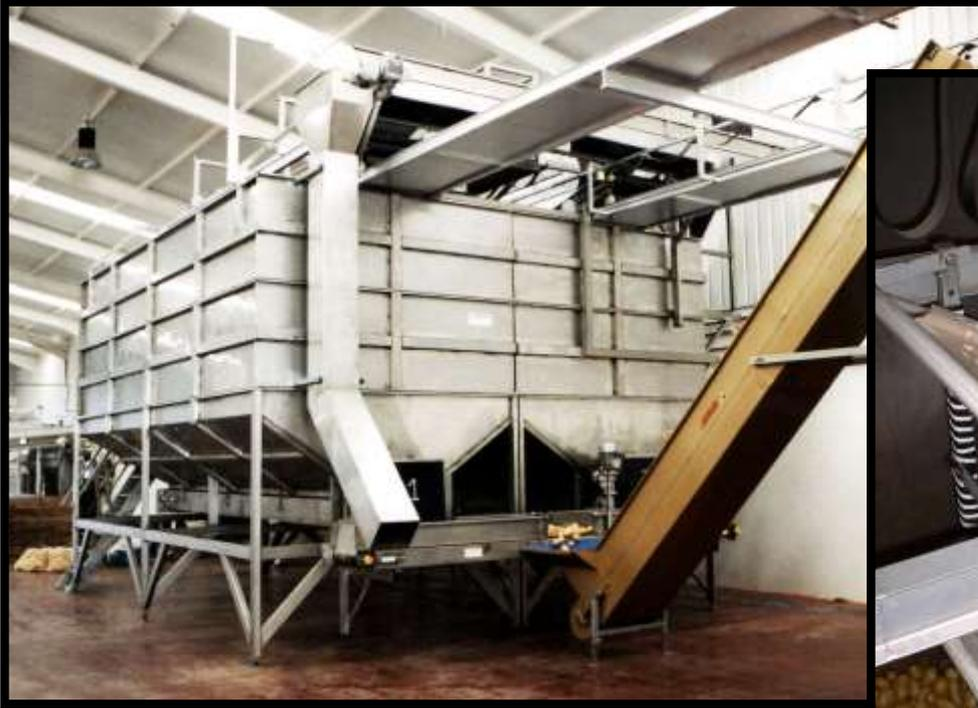
Les silos se construisent selon les besoins de production et de capacité, pour que chaque client obtienne une machine différente. Ils peuvent être construits en acier peint ou en acier inoxydable. Les contenances vont de 1000 kg à 40000 kg.
