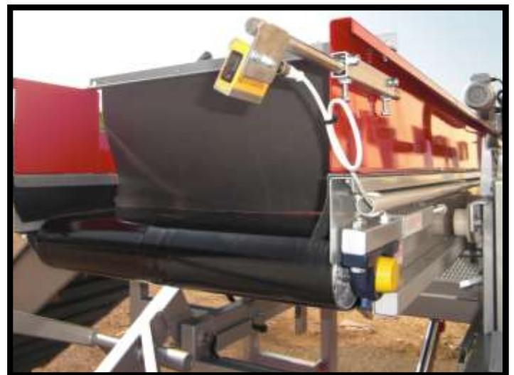
Le traitement du produit se fait de façon très douce moyennant des photocellules qui contrôlent le remplissage de la caisse.
