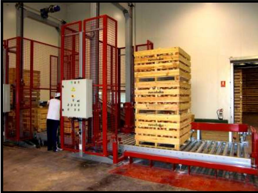
Machine très robuste pour palettiser ou dépalettiser automatiquement des colonnes de jusqu'à 4 palox avec une capacité de 120 palox/heure.
