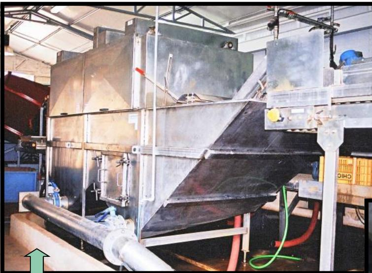
Escurredor de patatas para producciones de 5 a 25 Tn/h. La patata avanza de forma suave en los rodillos de fieltro, esto permite un escurrido muy efectivo de la patata.
