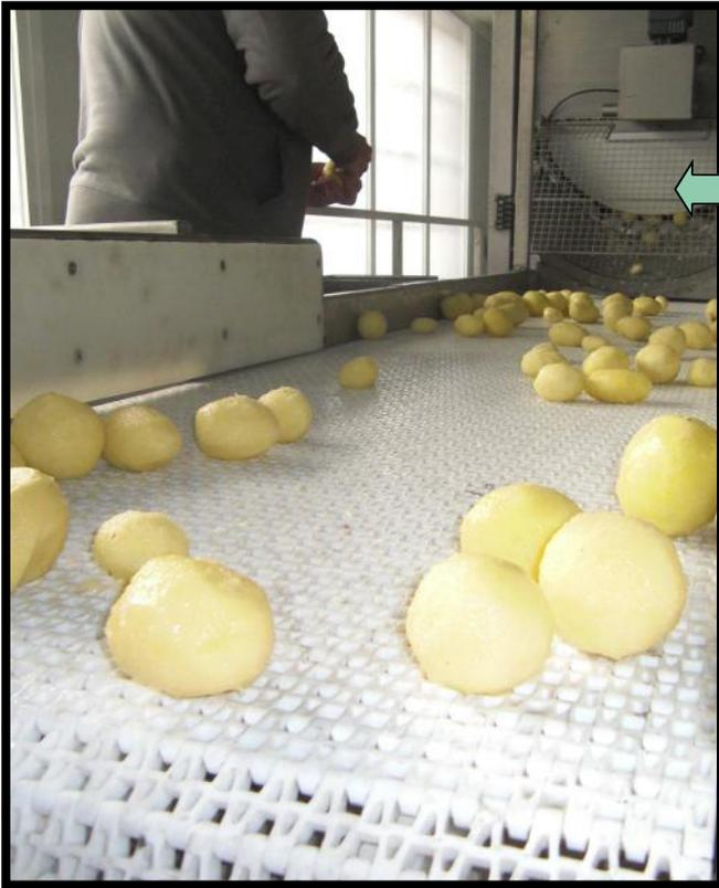
Línea de pelado y troceado de patata. Todo construido en acero inoxidable, y bandas de polietileno modulares atóxicas.
