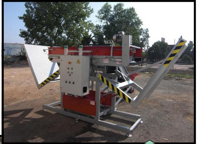
Maquina muy robusta para paletizar o despaletizar de forma automática torres de hasta 4 cajones con una capacidad de paletizado y despaletizado de 120 cajones/hora.
