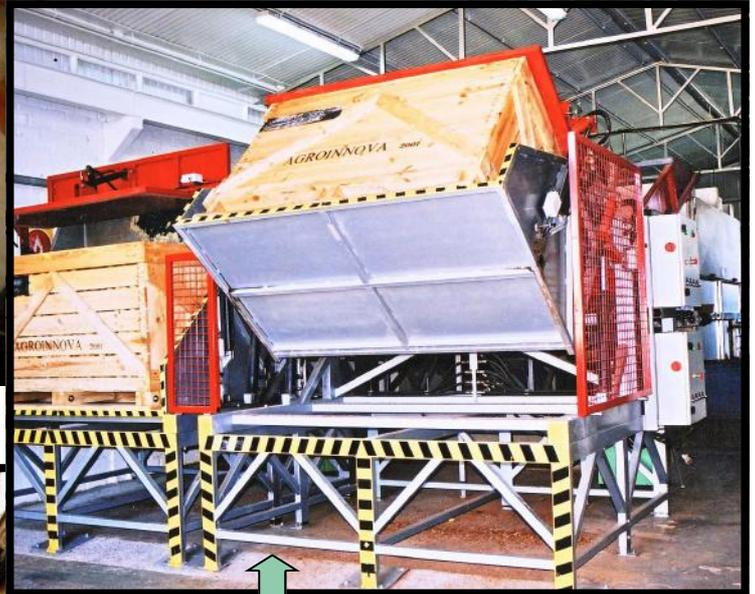
Volcador de cajones con tapa regulable en altura de forma automática y portilla de salida del producto. Capacidad para 40 cajones/hora.
