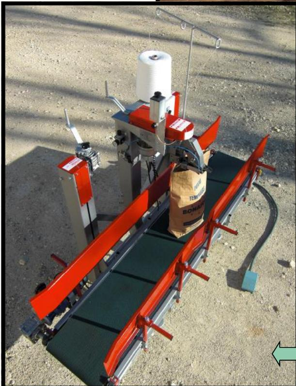
Pesadora semi-automática para pesos de 10 a 25 Kg. y hasta 50 Kg. en pesadas múltiples. Dispone de sistema de pesaje electrónico con 10 formulas para guardar. Producción de 5.000 Kg./hora en sacos de 25 Kg. y de 3.000 Kg./hora en sacos de 15 Kg., dependiendo del producto.
