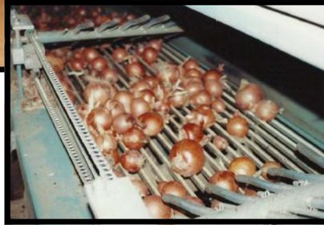
Cortadora por vibración y Cortadora de cordones. Chasis muy robusto y estanco con una cinta transportadora inferior para la recogida del destrio. Producción de 8Tn/h hasta 12 Tn/h máximo, según modelo.
