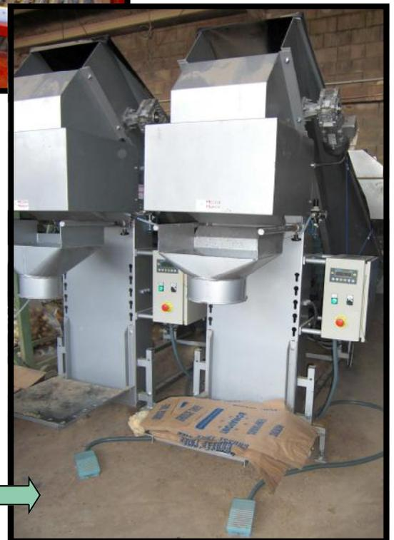
La Columna de cosido es una maquina muy robusta cuyas dimensiones se ajustan a las necesidades del cliente. La producción de cosido es de 600 sacos/hora. La máquina no requiere ningún mantenimiento especial.
