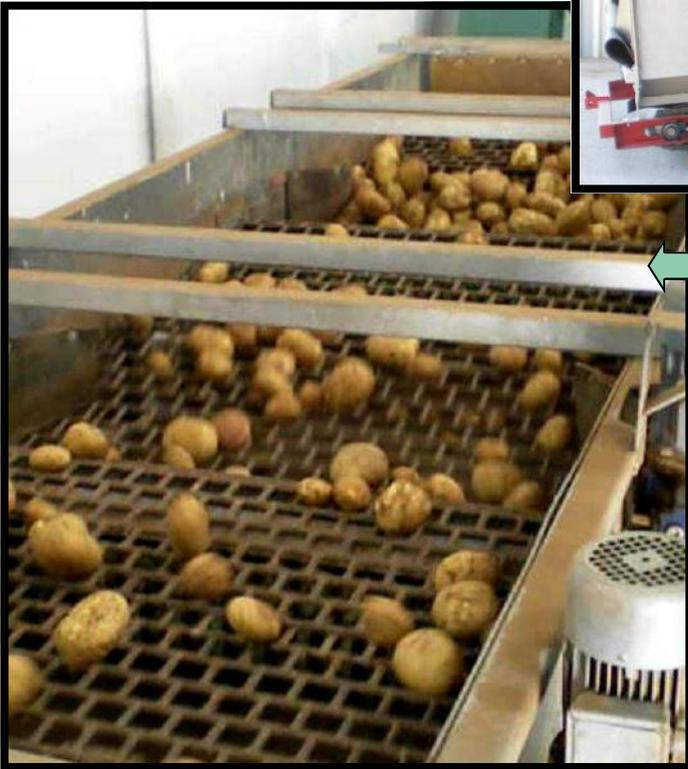
Calibrador de mallas. Máquina muy compacta. Producción de 8 a 30 Tn/h dependiendo del ancho de la máquina. El trato del producto es muy suave.
