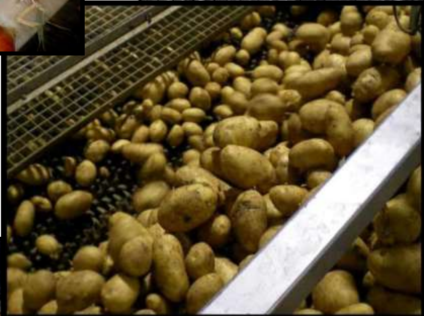
Detalle de los acabados del eliminador. Entrada, salida y laterales en PVC para evitar el roce del producto con el chasis.
