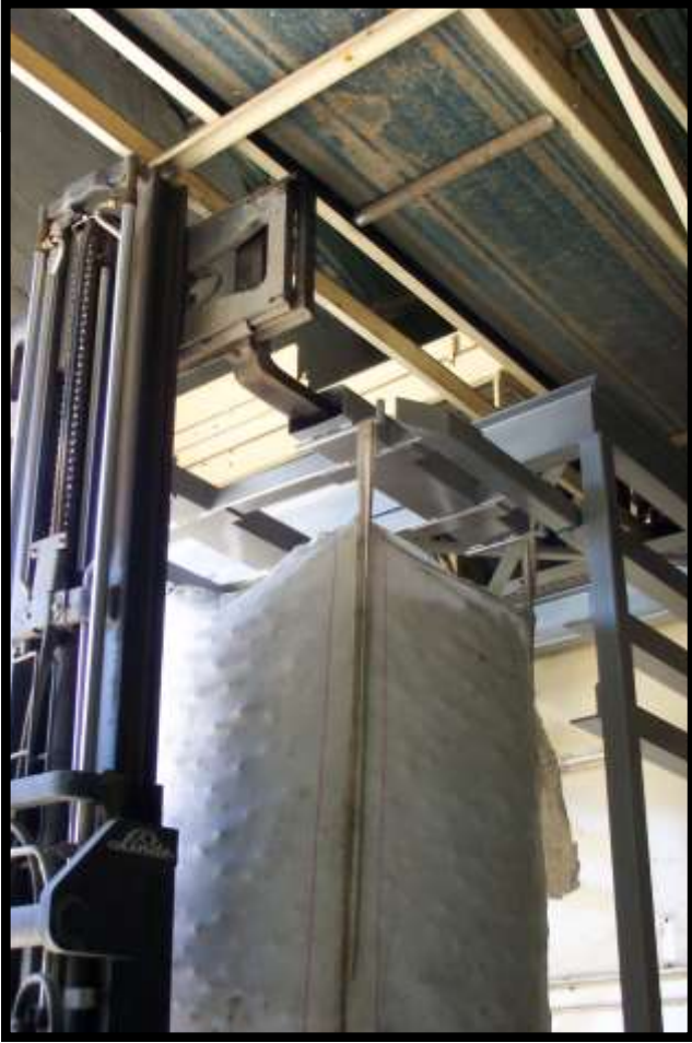
Detalle de la entrada del soporte de sacas a la estantería.
