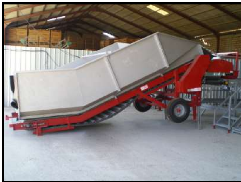
Bunquer de recepción Mod.2000 Quebrado. Producción de 25 Tn/h.
