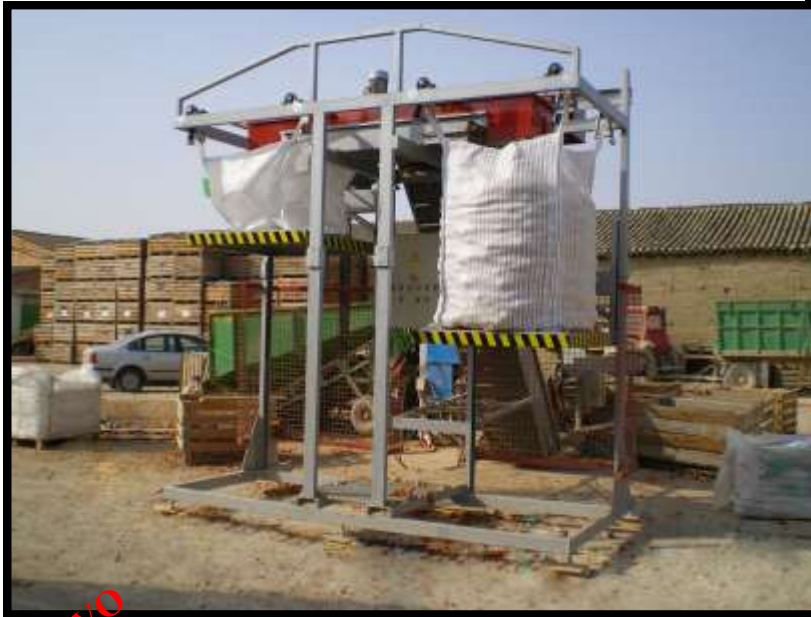
Modelo electromecánico para producciones de 25 Tn/h. Totalmente mecánico, muy silencioso y con altura inicial de descarga muy reducida, lo que consigue un trato muy suave del producto.
