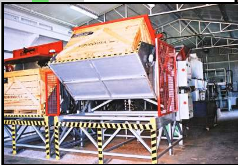
Volcador de cajones con tapa regulable en altura de forma automática y portilla de salida del producto. Capacidad para 40 cajones/hora.
