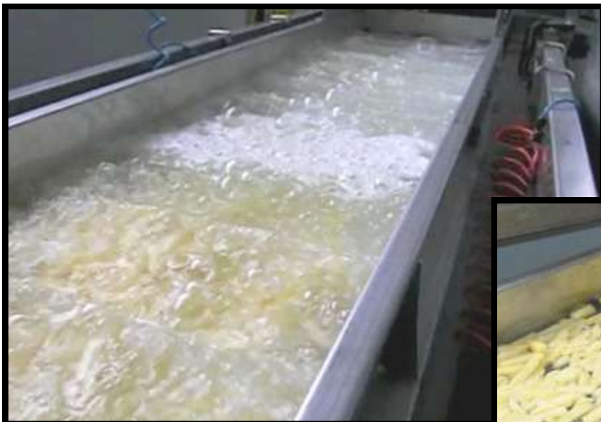
Balsa Blanqueador con sistema "jacuzzi" para mejorar el reparto del antioxidante por toda la superficie de la patata cortada.
