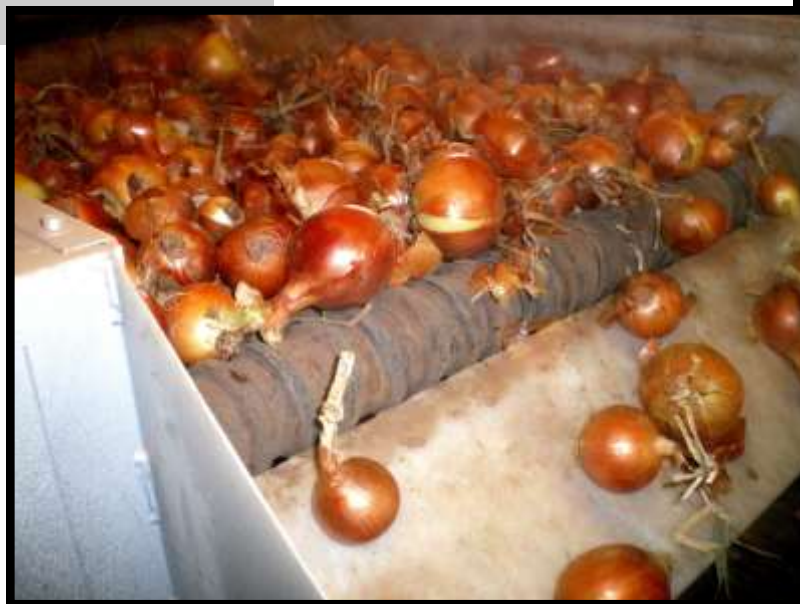
Modelo de eliminador de gomas helicoidales trabajando con cebolla.
