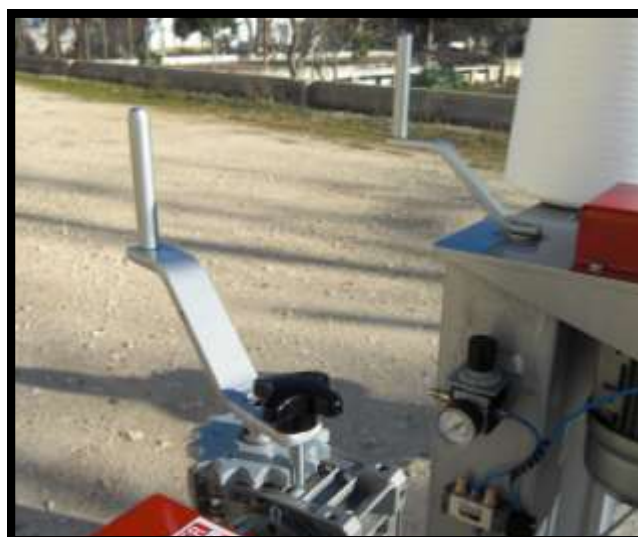
Detalle de las dos manivelas para el ajuste de alturas de la cinta y de la cosedora.
