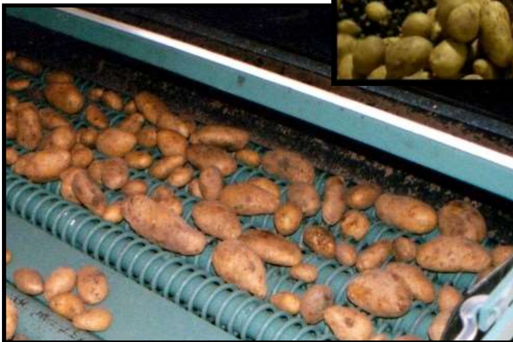
Modelo de eliminador de muelles trabajando con patata.
