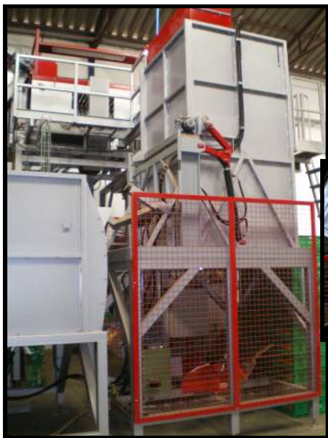
Volcador de sacas con tapa fija regulable de forma manual y portilla de salida del producto.
