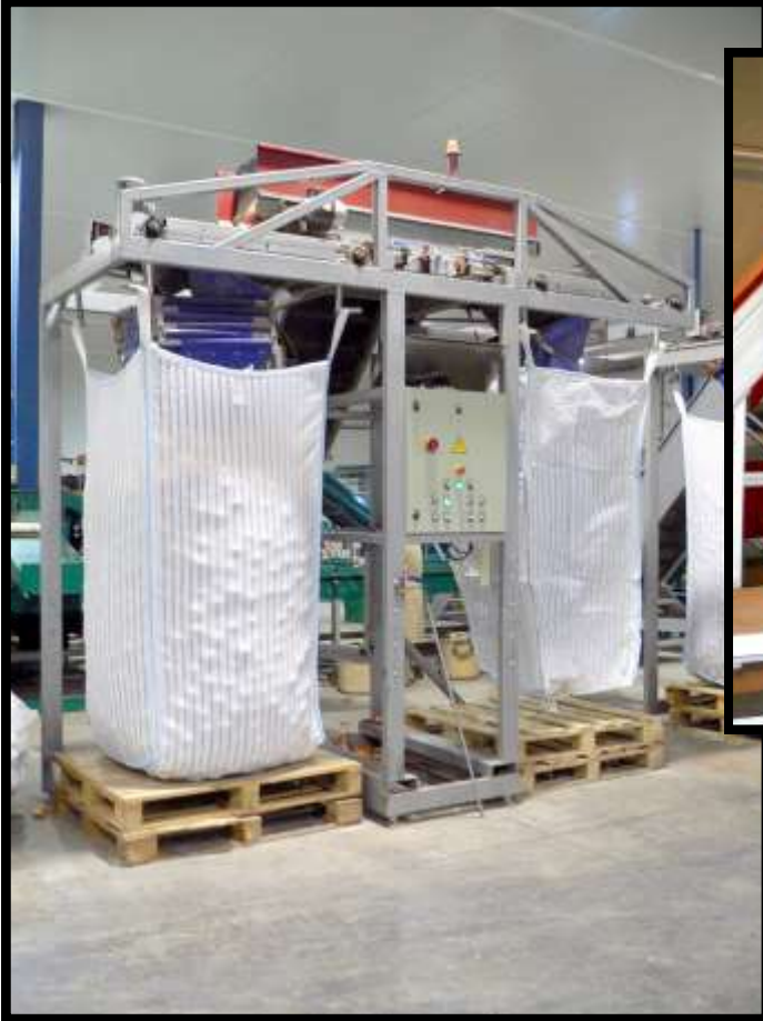
Modelo de ZIG-ZAG, ideal para producciones de 10Tn/h y un trato del producto muy suave, al descargar a poca distancia.
