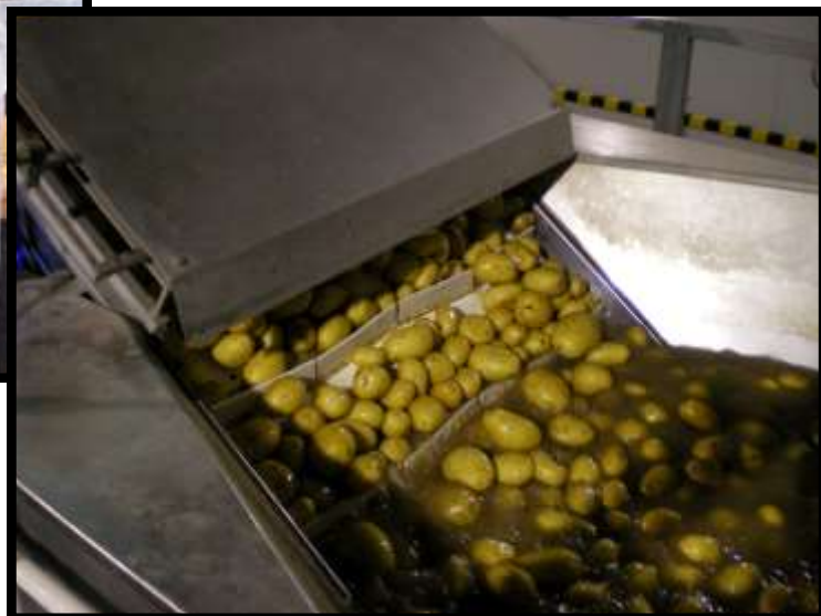
Elevador para la salida de producto con duchas para el enjuague final. La salida del producto se hace de forma muy suave.
