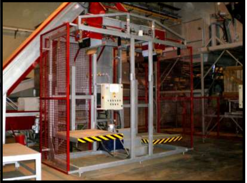
Modelo hidráulico para producciones de 25 Tn/h. Muy robusto y con un trato correcto del producto. Como en todos los modelos, el desenganche de la saca es automático.
