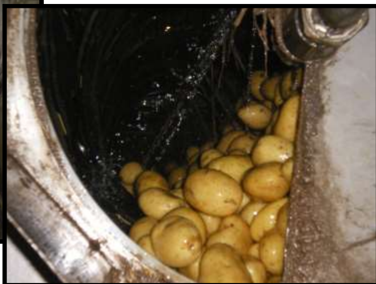
Detalle de la salida de agua a presión en el mod. de duchas. Las patatas se frotan entre ellas aumentando el nivel de limpieza del producto.
