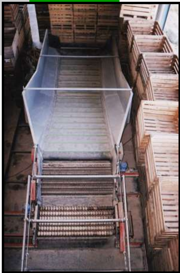
Conjunto Maxibunquer para mayor capacidad de producto con precalibrador a la salida
