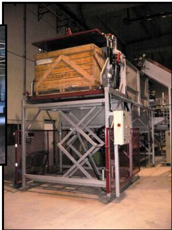
Modelo para cajones con plataforma inferior para retirar los cajones vacíos y cinta pulmón de recepción de producto. Conjunto para aumentar la cantidad de cajones descargados por hora.
