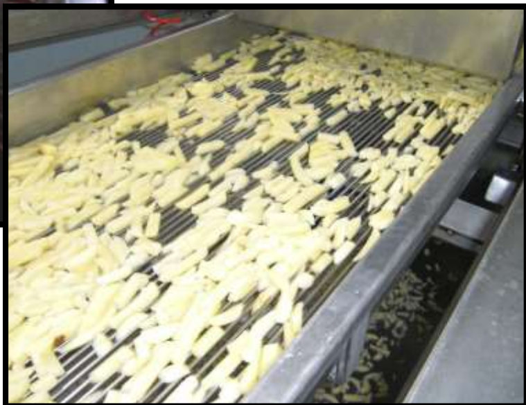
Balsa Blanqueador con sistema "jacuzzi" para mejorar el reparto del antioxidante por toda la superficie de la patata cortada.
