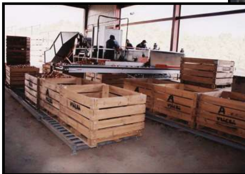
Detalle del camino de rodillos. Se aumenta la rapidez y facilidad de la descarga.
