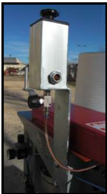
Detalle del sistema de engrasado por gravedad.
