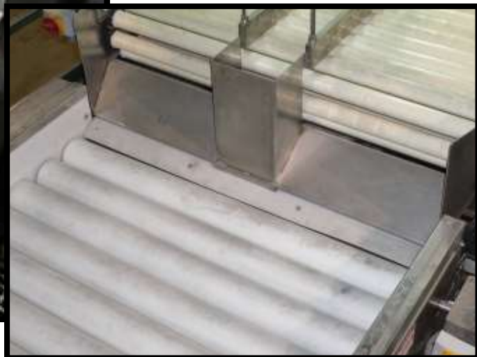
Detalle del escurridor. Los laterales son de PVC para el mejor trato de la patata.
