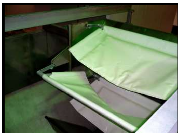
Las lonas del zig-zag también están reforzadas en el punto de descarga del producto. Esto las hace mas resistentes sin perder el buen trato del producto.
