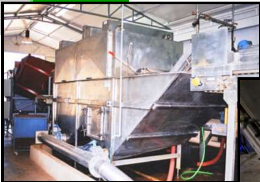
Lavadora de tambor sumergido para producciones de 5 a 30 Tn/h.
