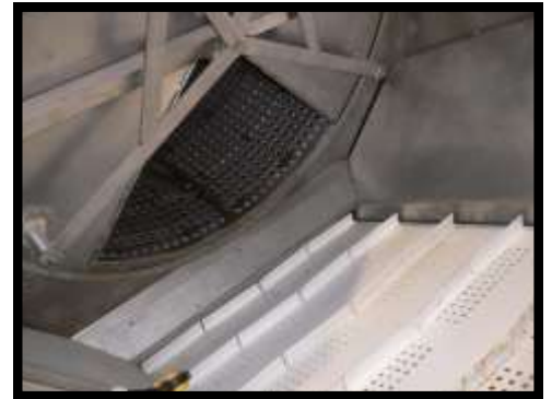
Tambor construido con chapa perforada abocardada para el buen trato del producto.
