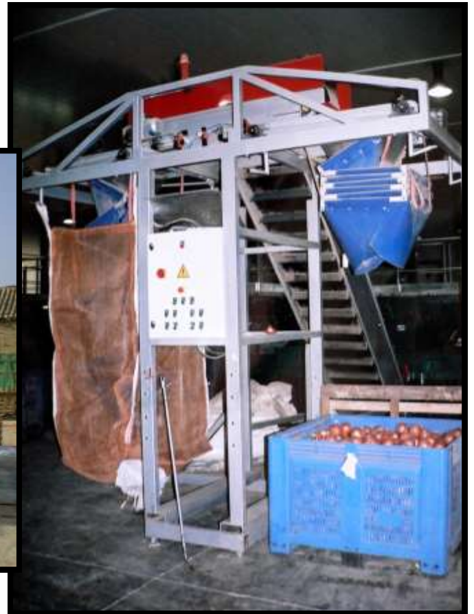
Modelo de ZIG-ZAG descargando simultáneamente a un cajón y a una saca.
